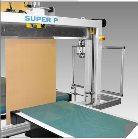
Este módulo opcional incrementa notablemente las prestaciones de las embaladoras CMB, pues ofrece la posibilidad de combinar en capas superpuestas multitud de materiales de embalaje, hasta ahora impensables. El resultado obtenido disfrutará de una excepcional protección.
